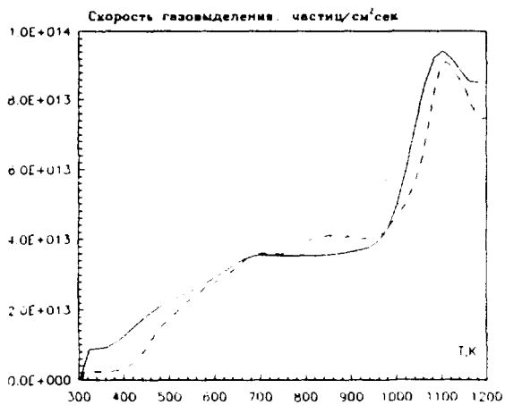
Рис. 4. Спектры газовой выделения водорода из бериллия, облученного в водороде (сплошная линия) и азоте (пунктирная линия) при T=920 K.
