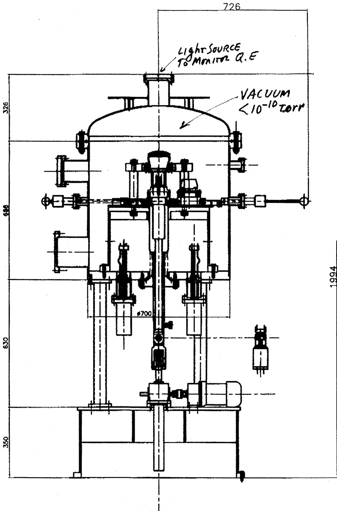
Dispositif pour fabrication photocathode HPD
