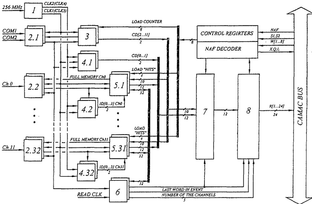
Рис.1. Блочная схема преобразователя время—код: 1 — формирователь тактовых сигналов, 2 — схемы селекции и синхронизации, 3 — счетчик «грубо», 4 — интерполяторы, 5 — память измерительного канала, 6 — управление памяти, 7 — блок вычисления действительного значения оценки временного интервала, 8 — буфер типа FIFO
