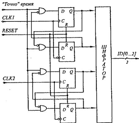
Рис.3. Блоковая схема интерполятора
