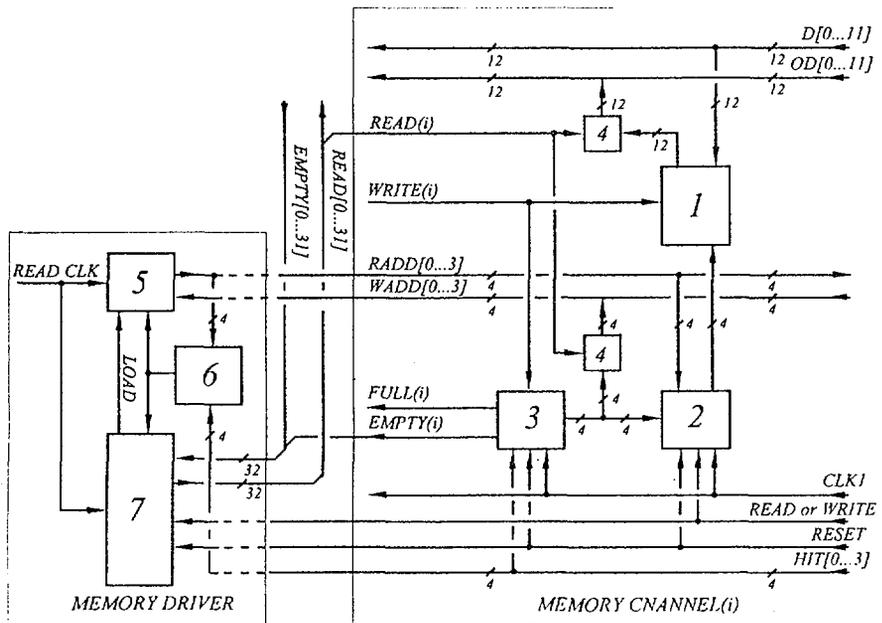
Рис.4. Блок-схема буферной памяти: 1 — память, 2 — мультиплексор адресов, 3 — адресный счетчик (АСЧ), 4 — буфер, 5 — общий адресный счетчик (ОАСЧ), 6 — компаратор, 7 — логика управления
