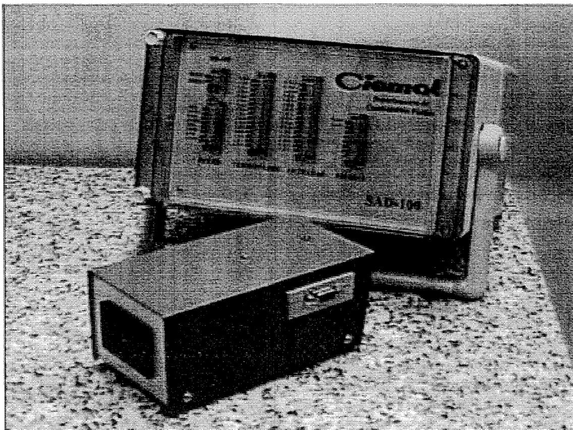
Figura 3. El SAD-100 con el módulo adaptador de línea serie.
