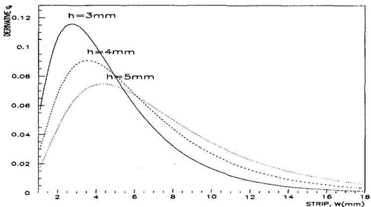
Рис. 9. Зависимость  $q'_r$  от  $W$  и  $h$  для  $s=2,5$  мм (мюон проходит через центр стрипа)
