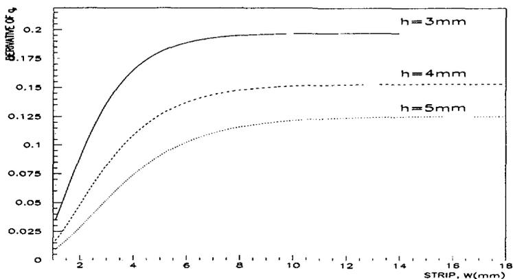
Рис. 8. Зависимость  $q'_r$  от  $W$  и  $h$  для  $s=2,5$  мм (мюон проходит между стрипами)
