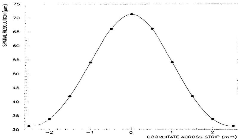
Рис. 10. Изменение координатной точности поперек стрипа
