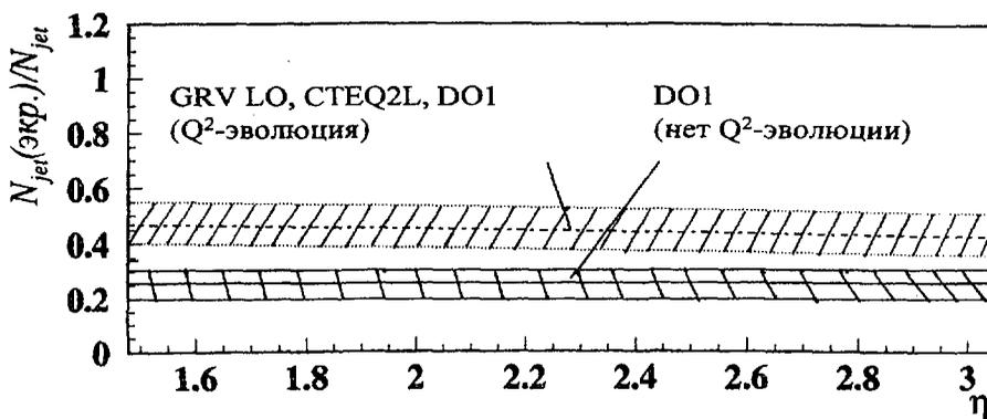
Рис. 3. Отношение числа (мини)струй, вычисленных с учетом экранирования, к числу (мини)струй, полученных в предположении отсутствия экранирования.  $PbPb$ -взаимодействие при  $\sqrt{S} = 5$  ТэВ/нуклон. Расчеты сделаны с учетом масштабной эволюции (пунктирная линия) и без (сплошная)
