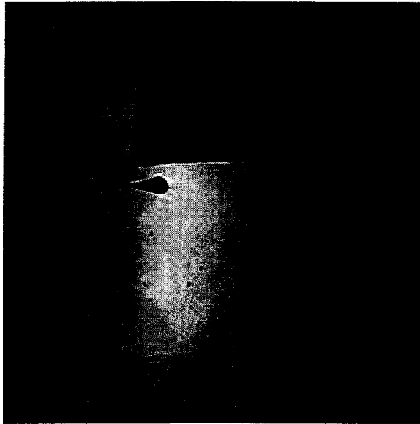
FIG. 6.13 – Image obtenue par ombroscopie. Le laser, se propageant de la gauche vers la droite, crée un plasma dans le jet de gaz. La buse correspond à la grande zone sombre qui occupe la partie supérieure droite de l'image alors que le plasma se traduit par une petite bulle sombre, juste au-dessous et sur le bord gauche de la buse.
