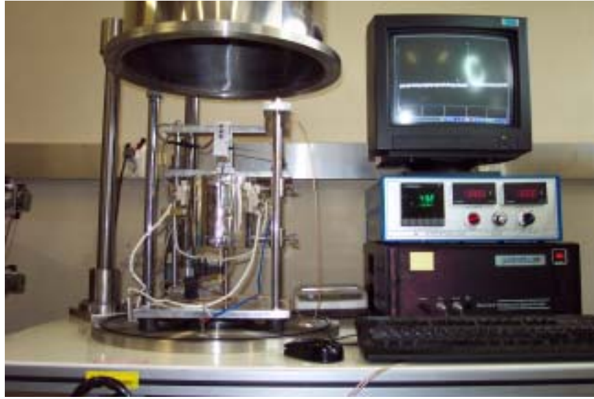
Photo 4-2. Bell Jar 내부 소형 가열로 및 초음파공명분광 시스템.
