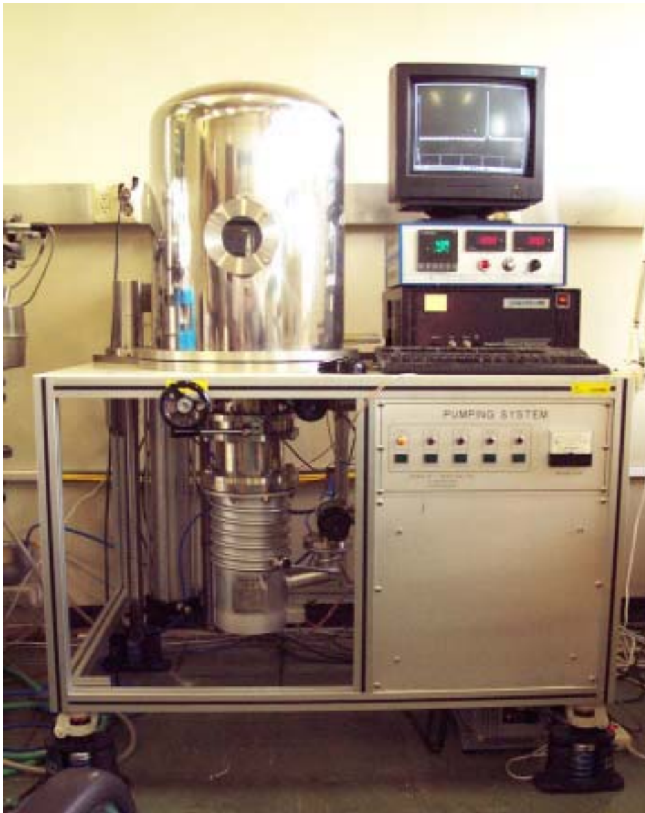
Photo 4-1. 제작된 고온/진공/정밀하중제어 초음파공명분광 실험 장치 전경.
