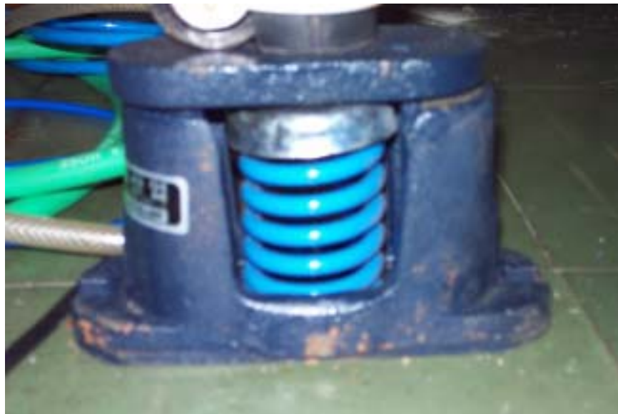
Photo 4-5. 고온/진공 초음파공명분광 시스템 충격 방지 장치.
