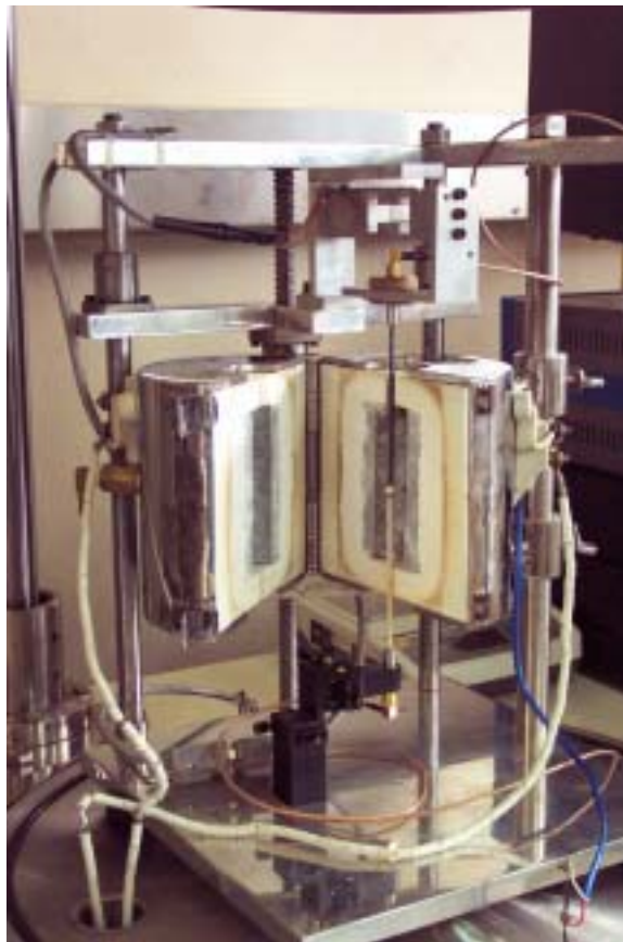
Photo 4-3. 소형 가열로 내부에 초음파 탐촉자 및 wave guide 에 시편이 장착된 모습.
