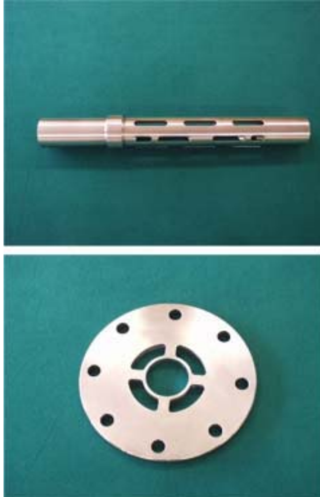
그림 3. Guide Tube(Mock-up) 부품도
