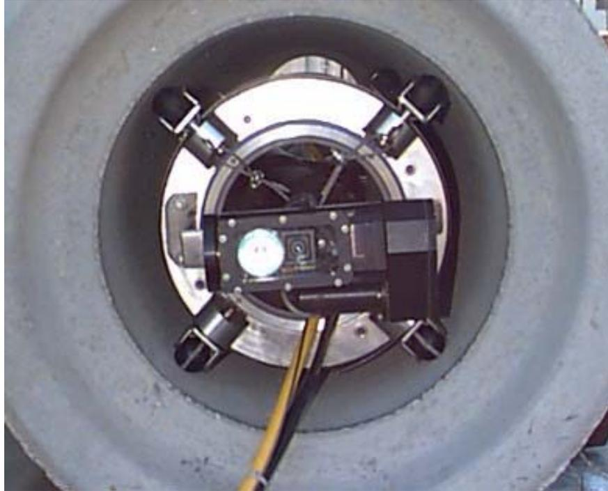
그림 5-4. 하수관 속에 투입하여 공기를 넣기 전의 모습
