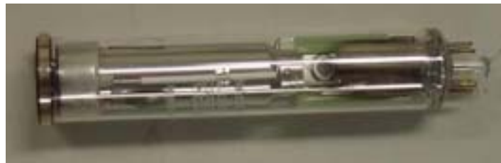
그림 34 비디콘 카메라 튜브의 외관
