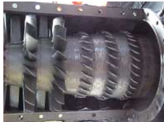
Figura 4 Destrucción de un compresor por operación en zona de inestabilidad
