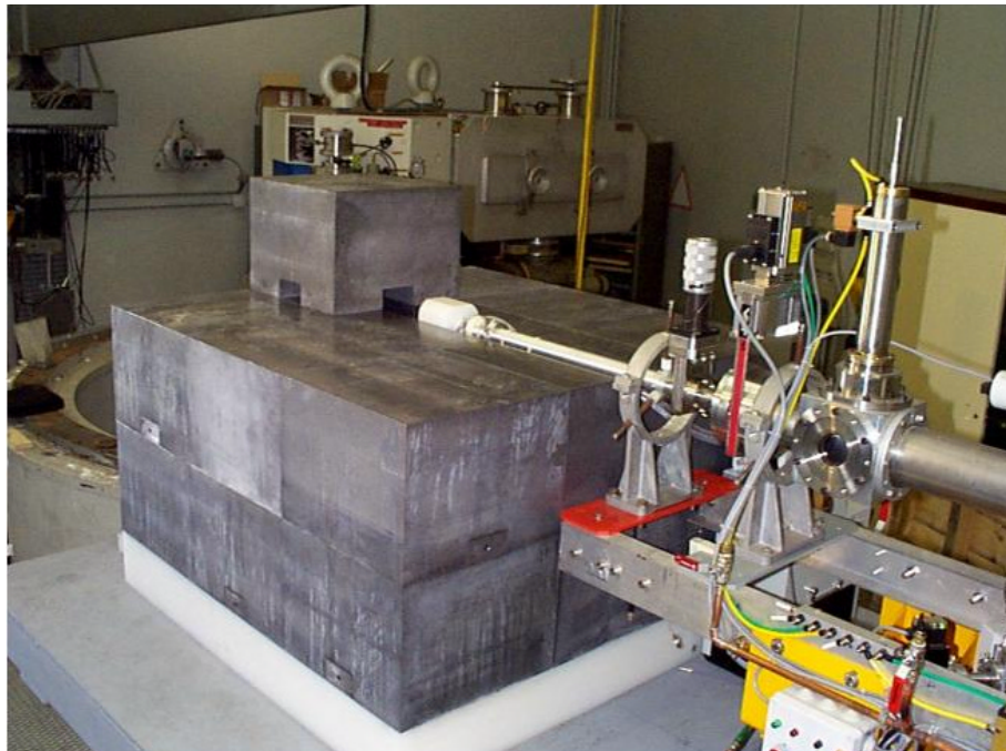
Photo I.1 : Vue de la partie inférieure du massif (en partie démonté) avec l'extension faisceau.
