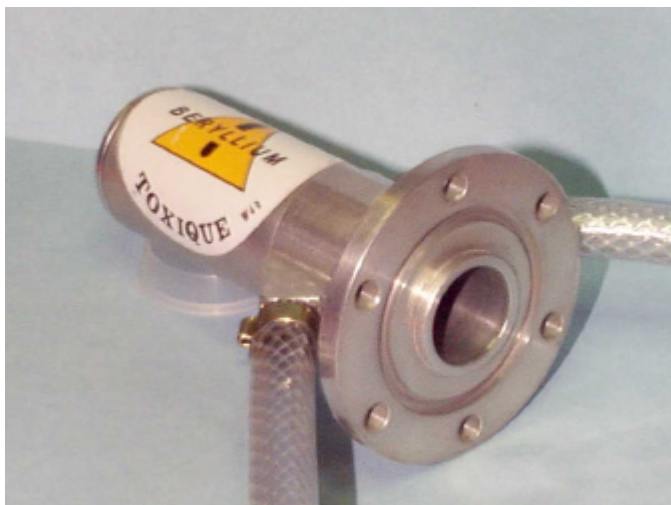
Photo I.3 : Cible refroidie par liquide.
