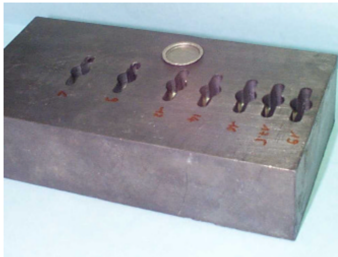
Photo I.4 : Brique porte-échantillons et coupelle en plomb.
