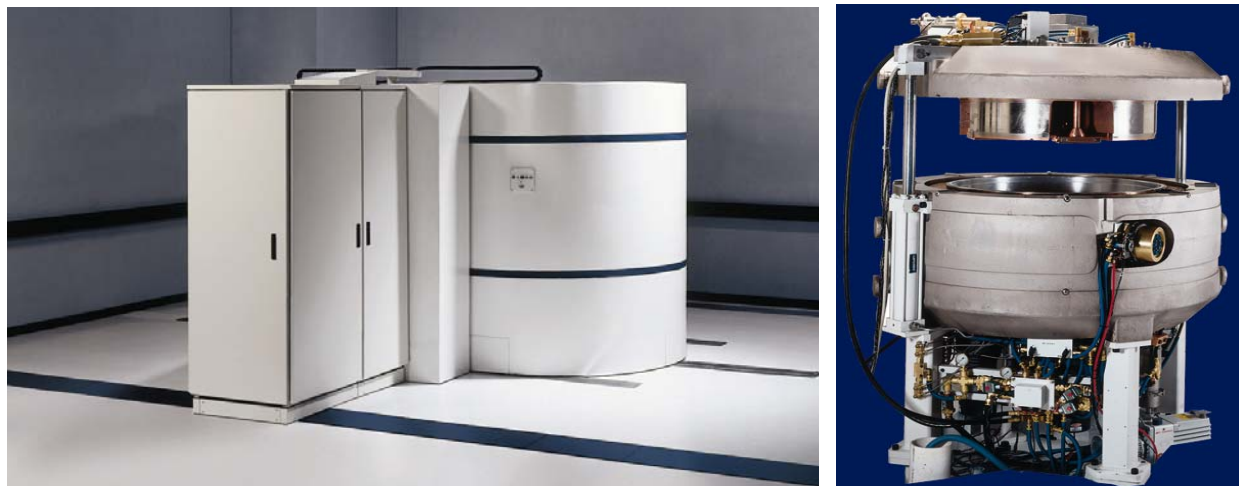
Figura 4. a) Vista panorámica del Acelerador de partículas tipo ciclotrón (RDS 111 de 11 MeV) y b) vista interna.
