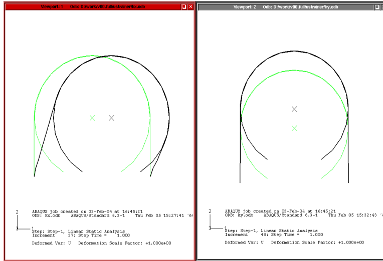
그림 1-11(b) U자형 고정쇠의 정적 변형해석
