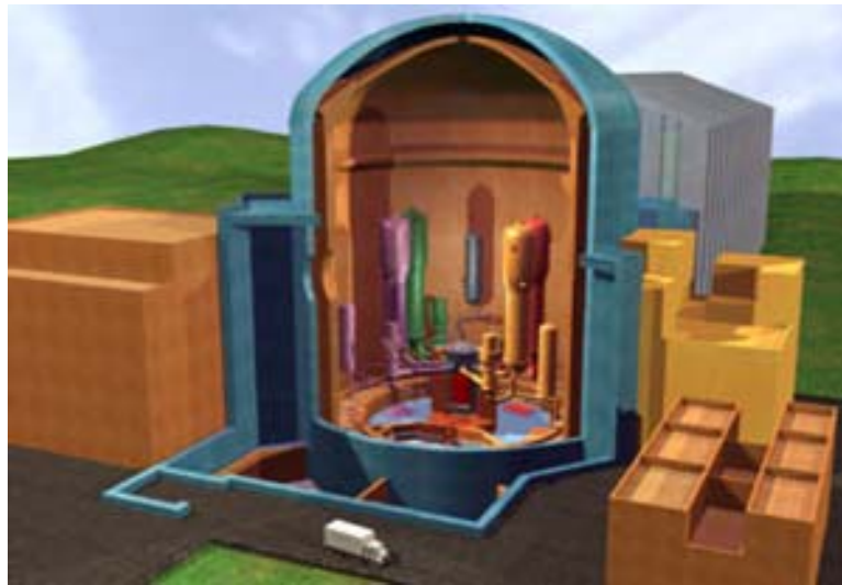
Figura 5. Edificio del reactor y la doble contención.
