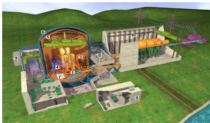
Figura 1. Esquema de una Central Nuclear con un EPR. 1) Vasija del Reactor. 2) Generadores de Vapor. 3) Presurizador. 4) Bombas de Enfriamiento del Reactor. 5) Contenedor Interno de Concreto pre-esforzado. 6) Barrera Externa de Concreto Reforzado. 7) Capa Refractora. 8) Cuarto de Control. 9) Edificio de Generadores Diesel. 10) Edificio de Turbinas.
