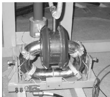
Рис. 5. Внешний вид импульсного трансформатора системы питания
