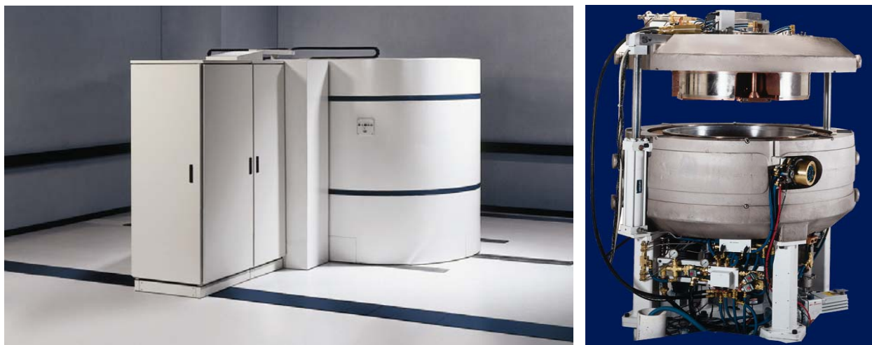
Figura 1. a) Vista panorámica y b) vista interna del Acelerador de partículas tipo ciclotrón (RDS 111 de 11 MeV).
