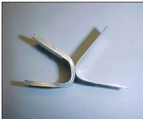
Fig. 10. Soldadura Al-SS. Ensayo de despegue
