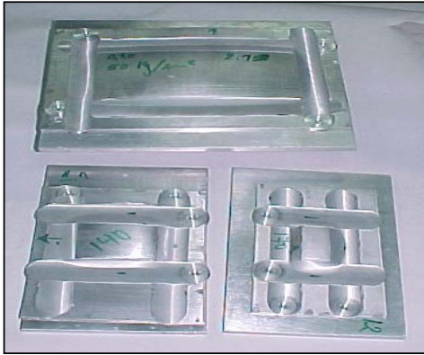
Fig. 12. Probetas de Al-Al para ensayo de inflado.
