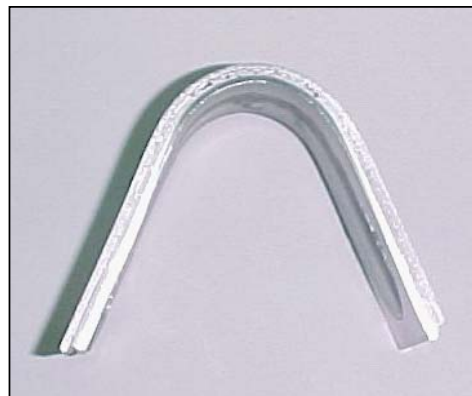
Fig. 11. Soldadura Al-Al. Ensayo de plegado
