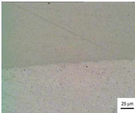
Fig. 14. Detalle de una de las interfaces Al-SS de un encapsulado pulido a paño con pasta de 1 μm.
