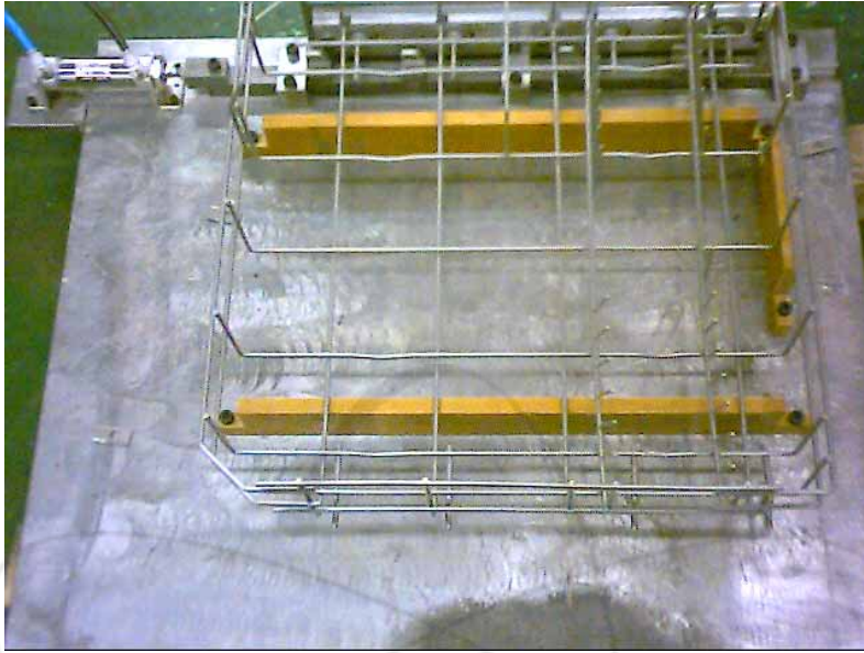
그림 2.8 롤러 A형 삽입을 위한 실험용 치구샘플
