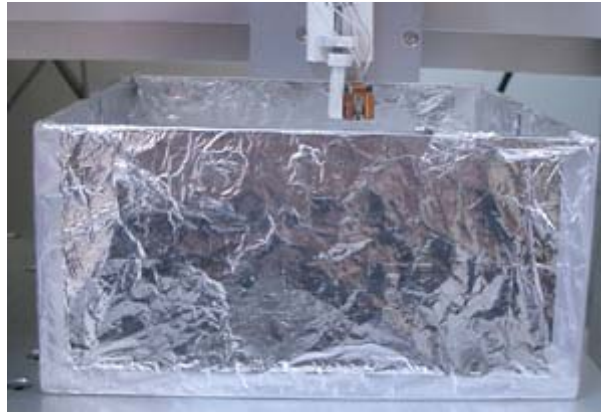
그림 13. 자기잡음 차폐를 위한 장치
