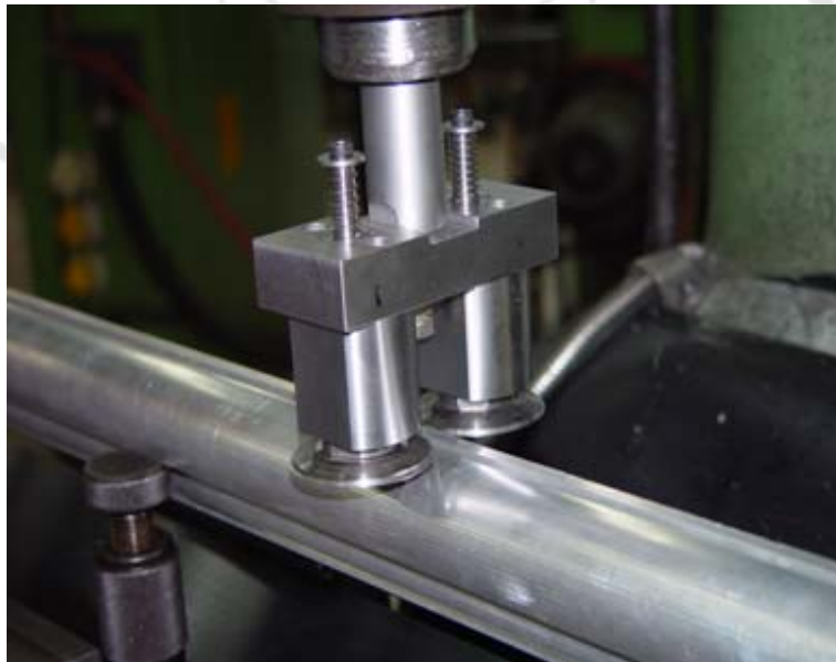
그림 3-4 곡관 핵연료 스웨징 가공 모습 (I)
