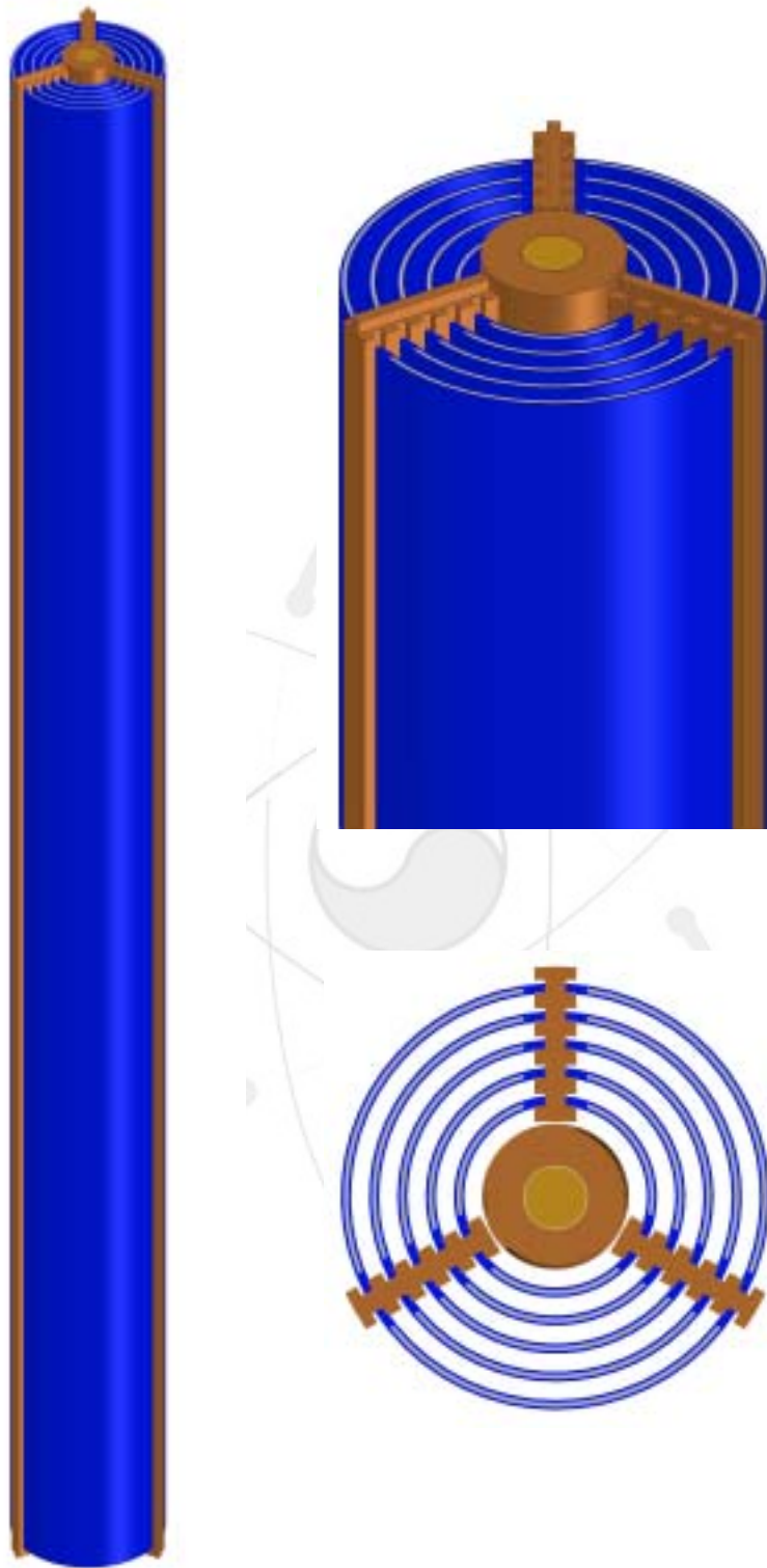
그림 4-19 감축 핵연료집합체의 곡판 핵연료, stiffener, spacer tube 및 central rod 의 조립도
