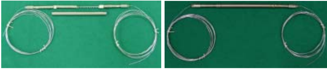
그림 5.6 핵연료 중심온도+핵연료 표면온도 이중계장용 핵연료봉
