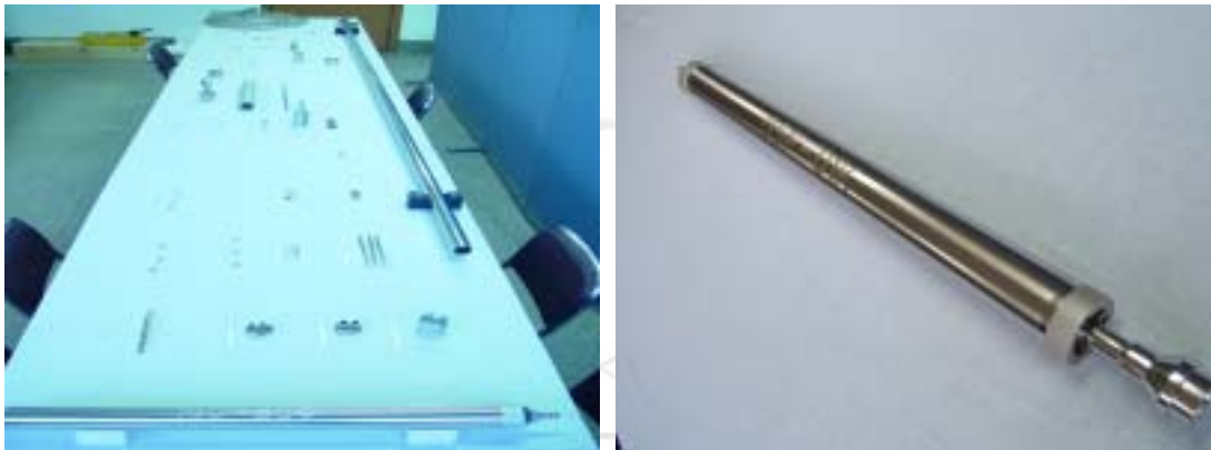
그림 5.7 핵연료 조사시험용 계장캡슐 부품 및 가조립 사진
