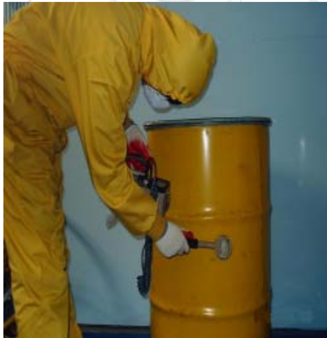
그림 16. 직접법에 의한 표면오염도 측정
