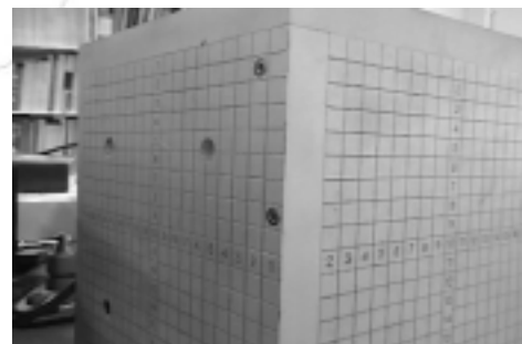
그림 94 영상 왜곡 보정을 한 후의 카메라 보정용 지그 영상
