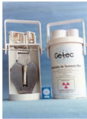
Figura 8. Generador de ^{99}\text{Mo}/^{99m}\text{Tc} producido en México en el ININ.
