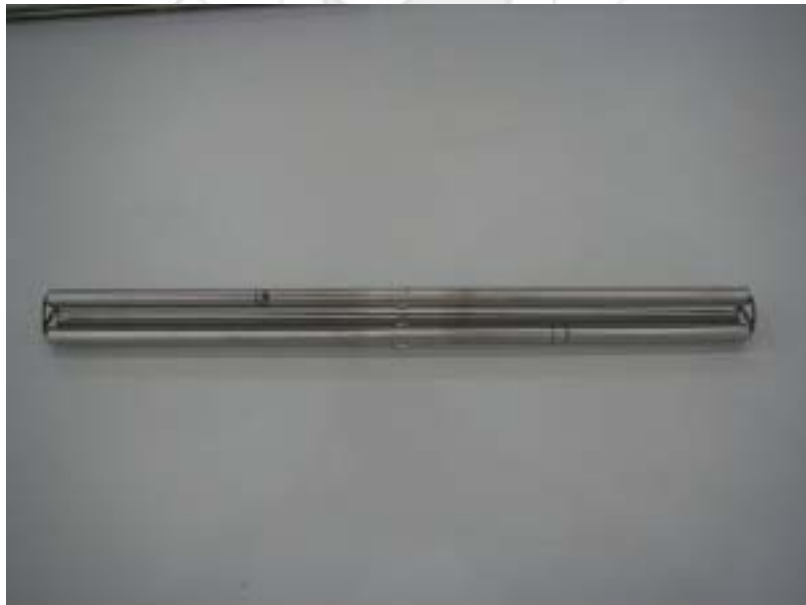
그림 43. 연료봉 3핀 집합연료 상·하단 접합관 용접모습.
