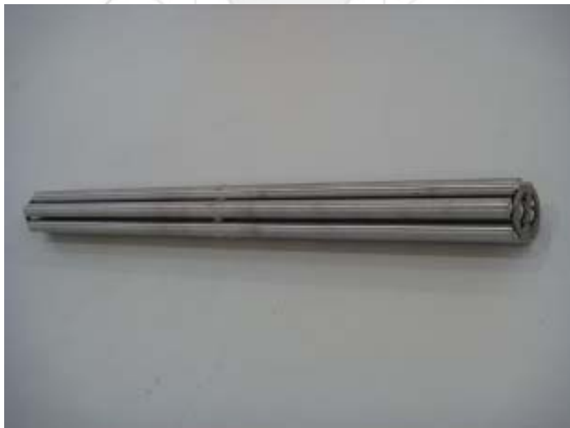
그림 40. 연료봉 7핀 집합연료 상·하단 접합판 용접모습.
