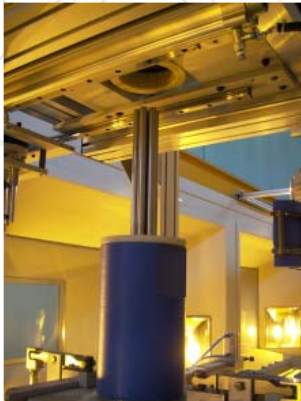
그림38. 연료봉 7핀 집합연료 지그의 시스템 중앙이송.
