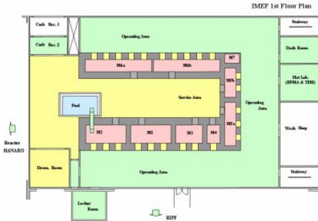
그림 1 조사재시험시설(IMEF) 내부 배치도
