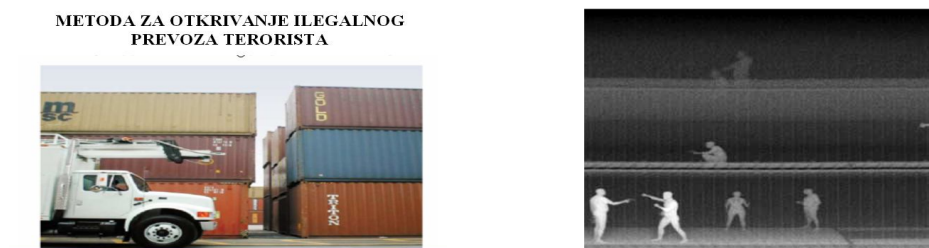
Slika 1. 4. Metoda na bazi skeniranja reflektovanih X-zraka visoke energije
