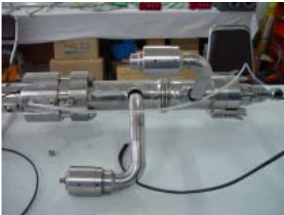
그림 4.4.1 Leak-Test for Neon gas interspace gap
