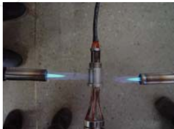
그림 4.3.4 Brazing of Instrumentation
