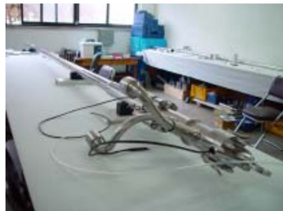
그림 4.4.4 Leak-Test for IPS Mock-up
