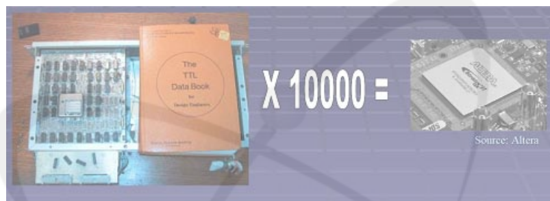
그림 3.4 Discrete 부품으로 구성된 보드의 기능을 FPGA로 구현
