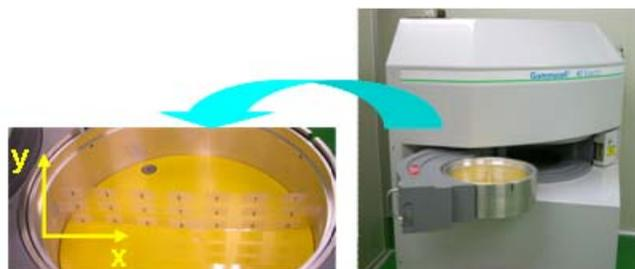
그림 41. Gammacell 40 Exactor
