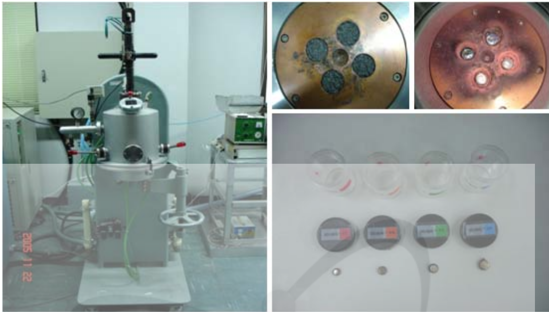
그림 32. Arc melting furnace와 Nd 혼합시료의 제조
