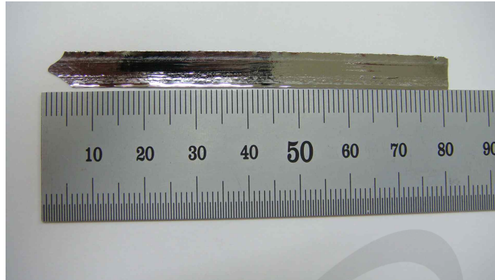
그림 15. melt spinning에 의해 제조된 Ti_{58}Zr_{16}Ni_{26} 리본
