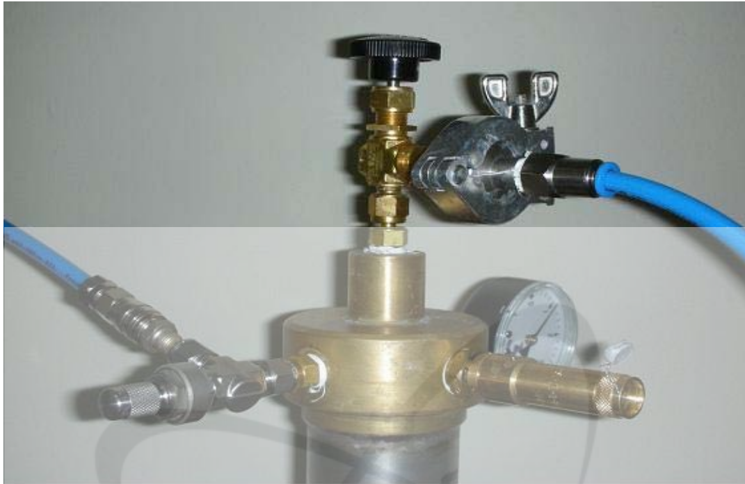
그림 2-15 inlet 및 outlet 밸브에 호스연결
