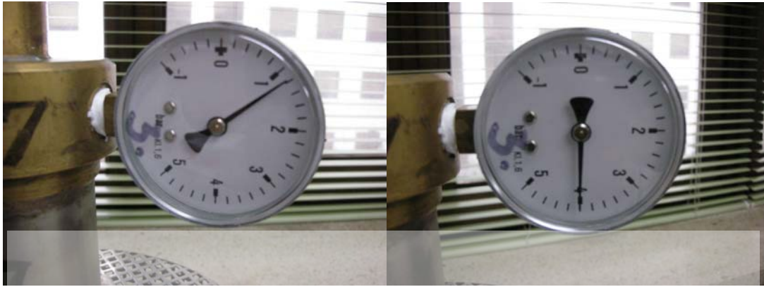
그림 3-12 300 °C 한 시간 가열 후 압력과 He 가스로 이송 후 압력계이지
