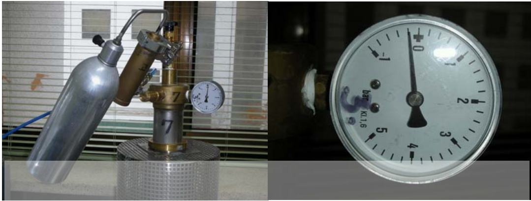
그림 3-10 탈착을 위한 미니캔 연결 및 연결 후 감압된 압력
