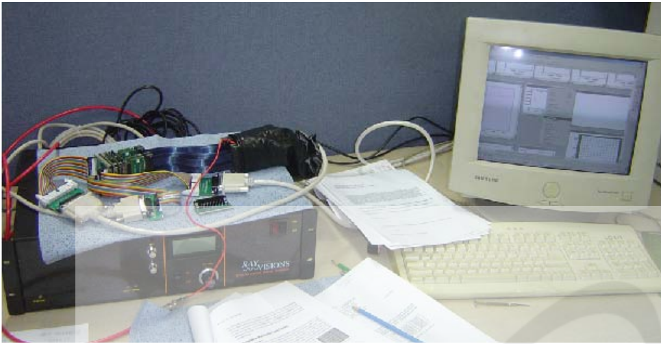
그림 17: 픽셀감마검출기가 광증폭기에 부착되고 ADC 신호처리 장치와 연결되어 컴퓨터 상에서 감마에너지 스펙트럼 측정을 위한 준비진행.
