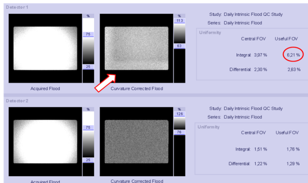
Figura 3. Artefato no controle de qualidade diário. Marcador de tireóide sem blindagem na sala de exames, encontrado em cima da bancada de medicamentos.
