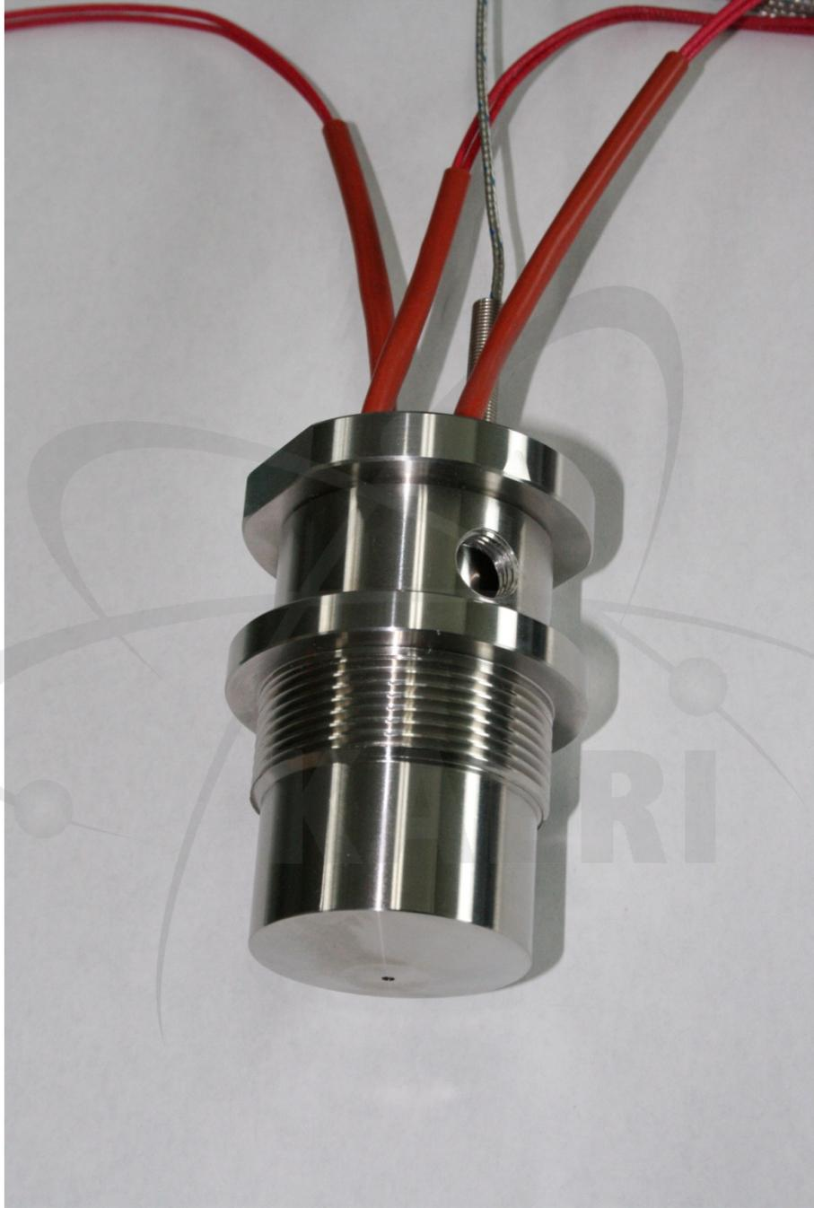
그림 10 분무노즐에 설치한 가열기 및 열전대
