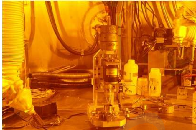
그림 22. Remote drilling of pellet at hotcell
