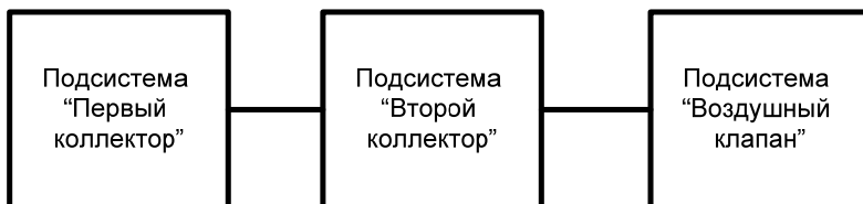
Рис.1. Функциональная схема системы нагнетания компрессорной станции.
