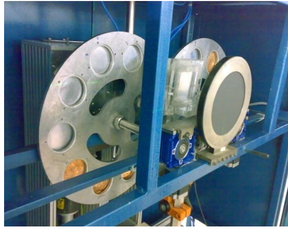
الشكل (3): وضعية التشعيع التي اعتمدت في مخبر المعايرة السوري باستخدام منبع ^{137}\text{Cs}
