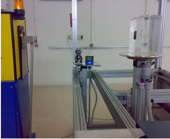
الشكل (3): وضعية التشعيع التي اعتمدت في مخبر المعايرة السوري باستخدام منبع ^{137}\text{Cs}
