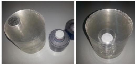
**Figura 4. Fantoma de acrílico con vial de solución acuosa.**
