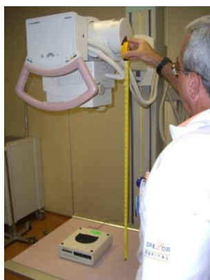
Figure 2: Posicionamento da câmara de ionização sob o tubo de raios X para o teste de atenuação.
