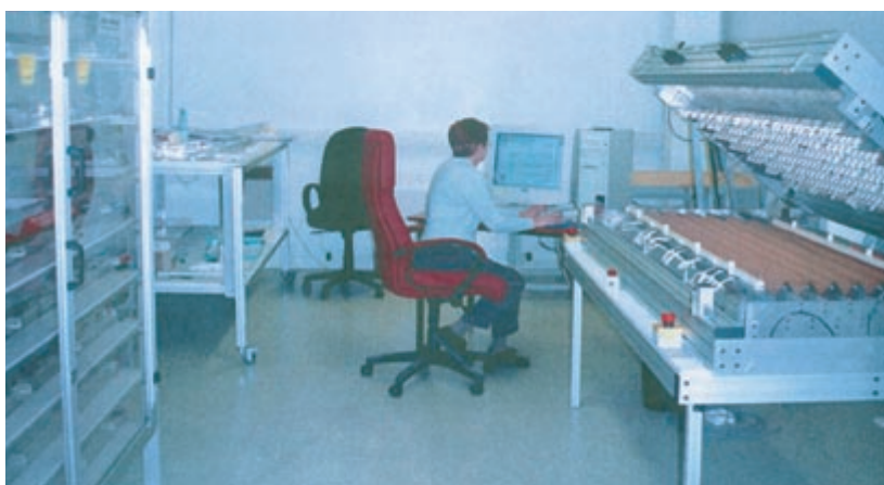
Fig. 2 : Banc de tests des électrodes ATLAS
