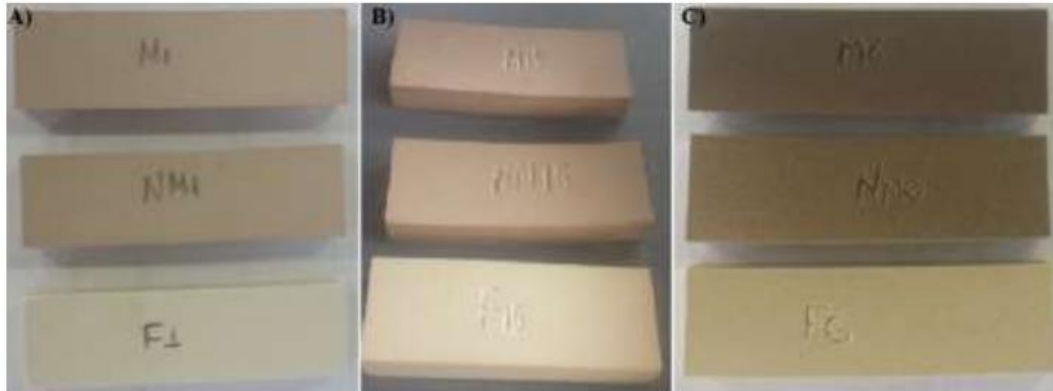
Figura 4 - Corpos de prova (de cima para baixo) F2, F3 e F1 após queima (a) à 1100°C; (b) à 1150°C e (c) à 1180°C (Fonte: autores, 2016)
