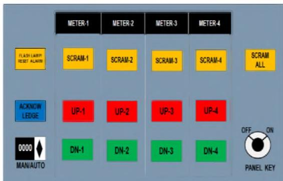
**Gambar 5.** Konsep rancangan panel kendali reaktor Triga-2000 bahan bakar tipe pelat
