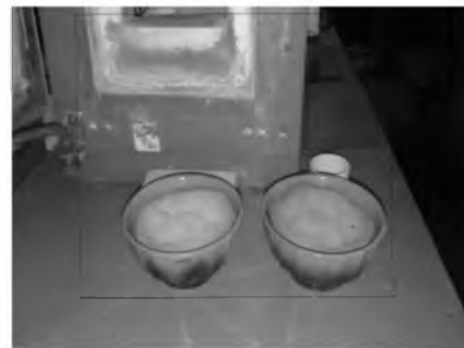
Gambar 2. Tungku suhu tinggi dan hasil leburan
