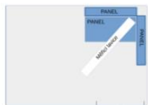
Schéma geometrického uspořádání panelů s vyšším obsahem přírodních radionuklidů v testovací místnosti a zamýšlené umístění měřicí kavičky.
