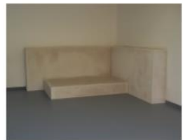
Pohled do připravované testovací místnosti s umístěnými panely se zvýšeným obsahem přírodních radionuklidů.
