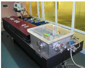
Рис. 1. Тераваттная фемтосекундная титан-сапфировая лазерная система AVET-10
