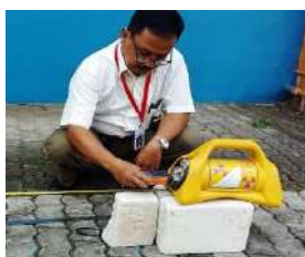
Gambar 2. Pengukuran laju dosis ambien pada kamera radiografi model 880 Delta menggunakan surveimeter Inspector
