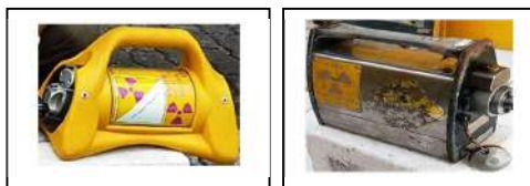
Gambar 1. Peralatan radiografi model 880 Delta (kiri) dan model Tech Ops 660 B (kanan) yang diuji unjuk kerjanya
